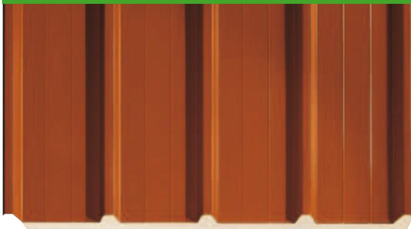
Pannello progettato per l'impiego di coperture a falda inclinata. Caratterizzato da un'interessante economicità, presenta una superficie interna in cartongesso bitumato, mentre la lamiera esterna viene realizzata nel profilo a cinque greche.
