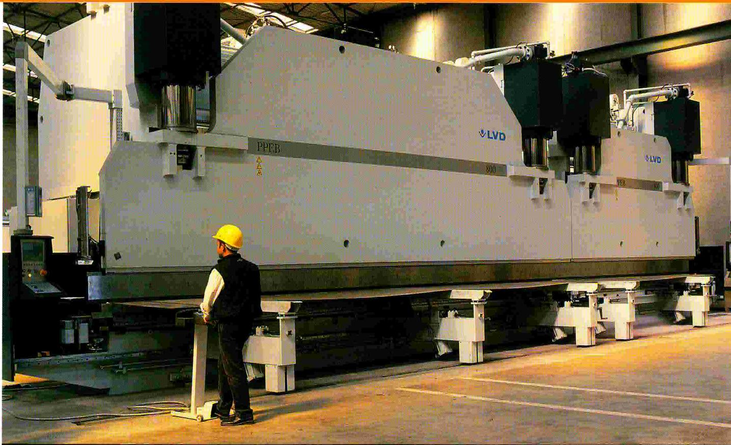
**CARATTERISTICHE** Potenze: da 200 a 1.600 tons - Lunghezze: fino a 14.000 mm.
