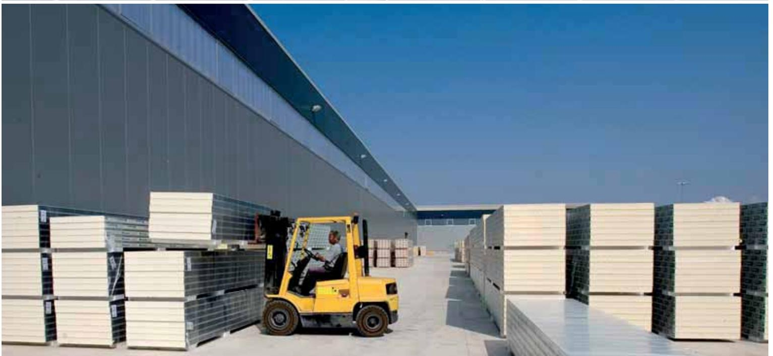
Il ciclo produttivo Isopan è in perfetta sintonia con l'ambiente: i pannelli, costituiti essenzialmente da un supporto in profilato metallico e da uno strato di massa isolante in poliuretano o fibra minerale, sono realizzati tramite impianti innovativi in grado di ridurre l'impatto ambientale del processo produttivo.
