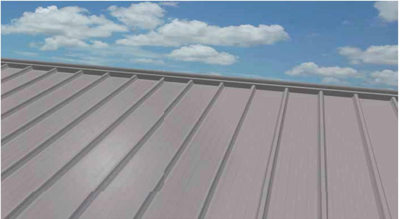
Pannello sandwich a doppio rivestimento metallico, per coperture con pendenza non inferiore a 7%, coibentato in poliuretano, con lamiera esterna profilata a 4 greche per aumentare la resistenza ai carichi statici e dinamici. Il fissaggio è a vista, con apposito cappellotto con guarnizione. Grazie alla conformazione della greca a coda di rondine, è possibile integrare la copertura con appositi accessori.
