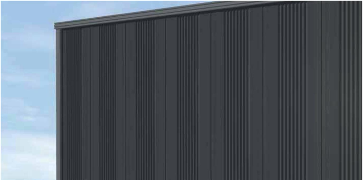
Pannello da parete a doppio rivestimento metallico con isolamento in poliuretano. Il giunto, con incastri maschio-femmina, è di tipo nascosto, con vite passante. Disponibile in diversi tipi di profilatura.
