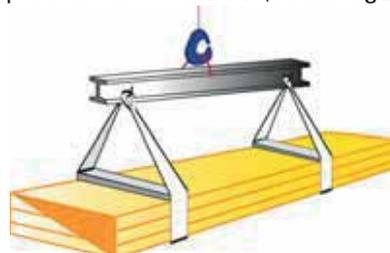
Devono essere impiegati appositi distanziatori posti al di sotto e al di sopra del pacco, costituiti da robusti elementi piani di legno o materiale plastico, che impediscano il diretto contatto delle cinghie con il pacco.
